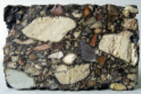
Asphalttragschicht 0/32 CS ZTVT-StB
