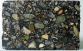
Asphalttragdeckschicht 0/16 ZTV-LW Ländliche Wege
